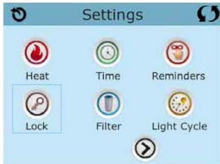
Le contrôle peut être restreint pour empêcher une utilisation non souhaitée ou des ajustements de température.
